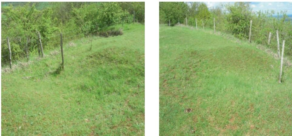
Figure 5 – Dépression pouvant être l'indice d'un effondrement en préparation à Lorry-Mardigny (Moselle) ou la cicatrice d'un effondrement ancien (celui de la figure 3 est visible à l'arrière-plan sur la vue de gauche).
